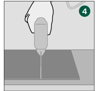
Sägen Sie die Länge zu, am besten mit Hilfe einer Stichsäge. Legen Sie die Diele mit der Dekorseite auf die Sägeunterlage. Als Alternative kann eine feingezahnte Handsäge benutzt werden, aber dann muss die Dekorseite nach oben zeigen.
