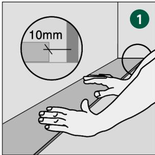
Legen Sie das erste Element entlang der Wand aus. Dabei werden die Federseiten gegen die Wand gelegt. Achten Sie darauf, dass Sie ca. 10 mm Abstand zwischen der Stirnseite der Diele und der Wand haben. Der Abstand der Längsseite von der Wand (ca. 10 mm) kann später festgelegt werden, wenn drei Reihen verlegt worden sind.
