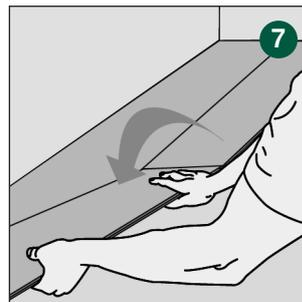
Drücken Sie stirnseitig die nächste Diele schräg in die erste und legen Sie diese auf den Boden. Dabei soll die Längsseite auf der Verriegelungsseite der vorhandenen Diele gelegt werden.
